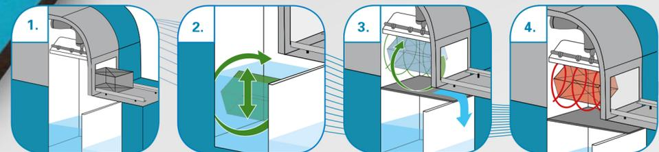
1. Der Korb wird von dem Auflagetisch in die Dreheinrichtung der Anlage geschoben.
